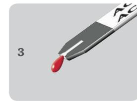
3. Nanesite uzorak krvi na prednju stranu žutog prozorčića test trake. Čut će zvučni signal kad je dovoljno krvi naneseno na test traku.
