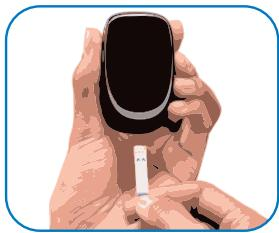
1. Uključite mjerič umetanjem test trake.
