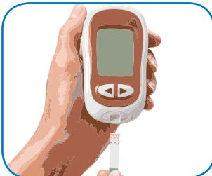
1. Uključite mjerač umetanjem test trake.
