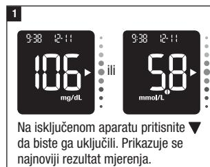
Na isključenom aparu pritisnite ▼ da biste ga uključili. Prikazuje se najnoviji rezultat mjerjenja.
